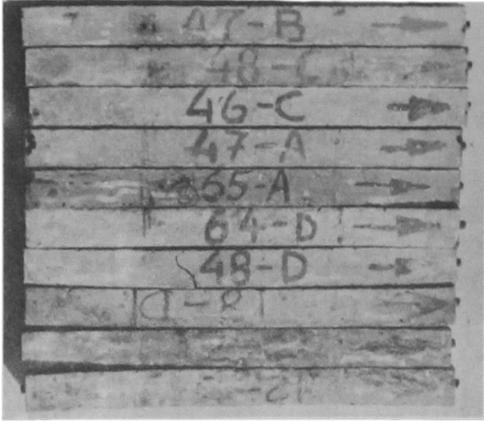
Fig. 4. Barras confeccionadas y ensayadas en IDIEM con áridos reactivos de la zona de Antofagasta y cementos nacionales.
