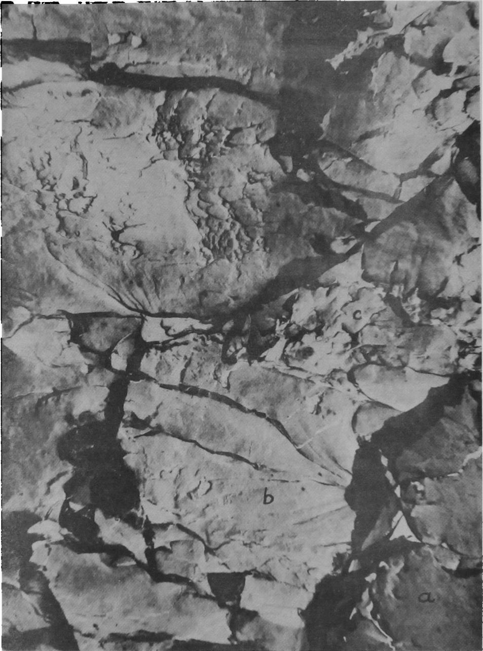
Fig. 1. Acero de construcción fracturado por tracción. Se observa: a) Zona de fractura por decohesión. b) Zona de fractura por clivaje. c) Zona de fractura dúctil. 4.500 X.
