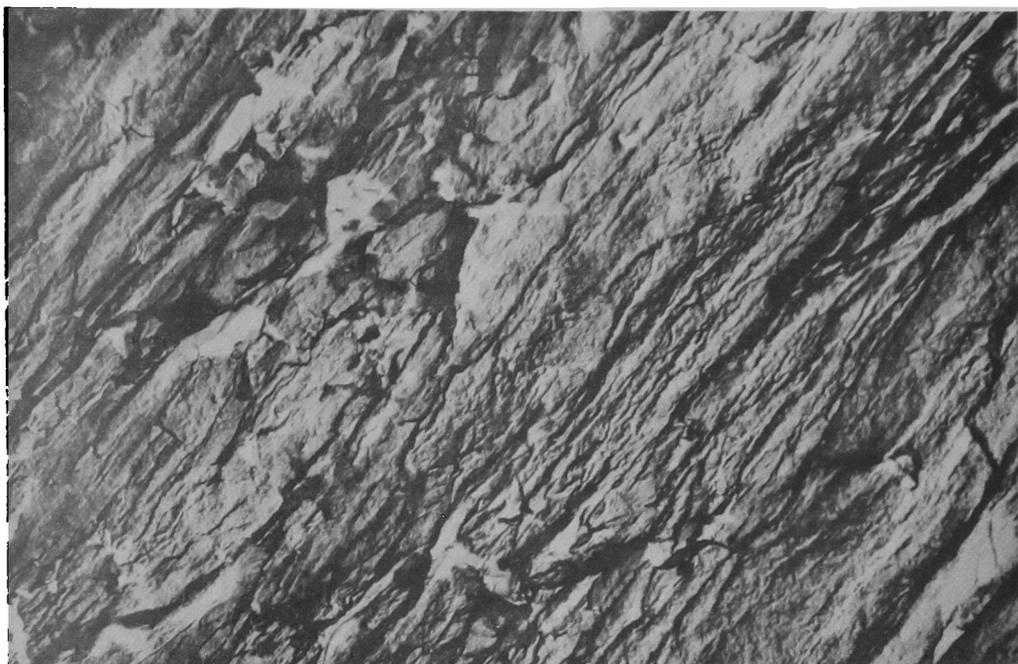
**Fig. 3. Acero de construcción fracturado por tracción. Fractura dúctil de muy pequeño entramado. 12.500 X.**
