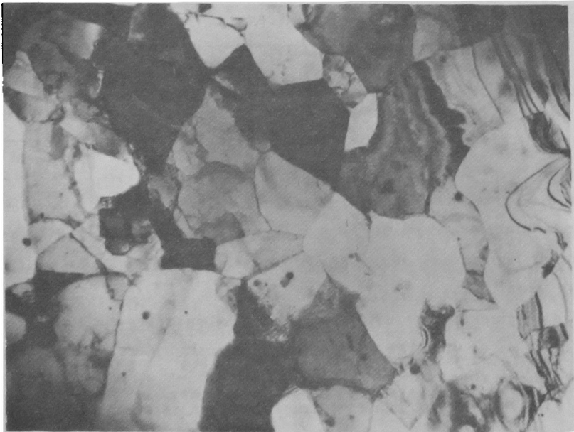
Fig. 5. Cristalitas obtenidas después de una reducción de 200% por laminación en aluminio policristalino de 99,99% de pureza.
