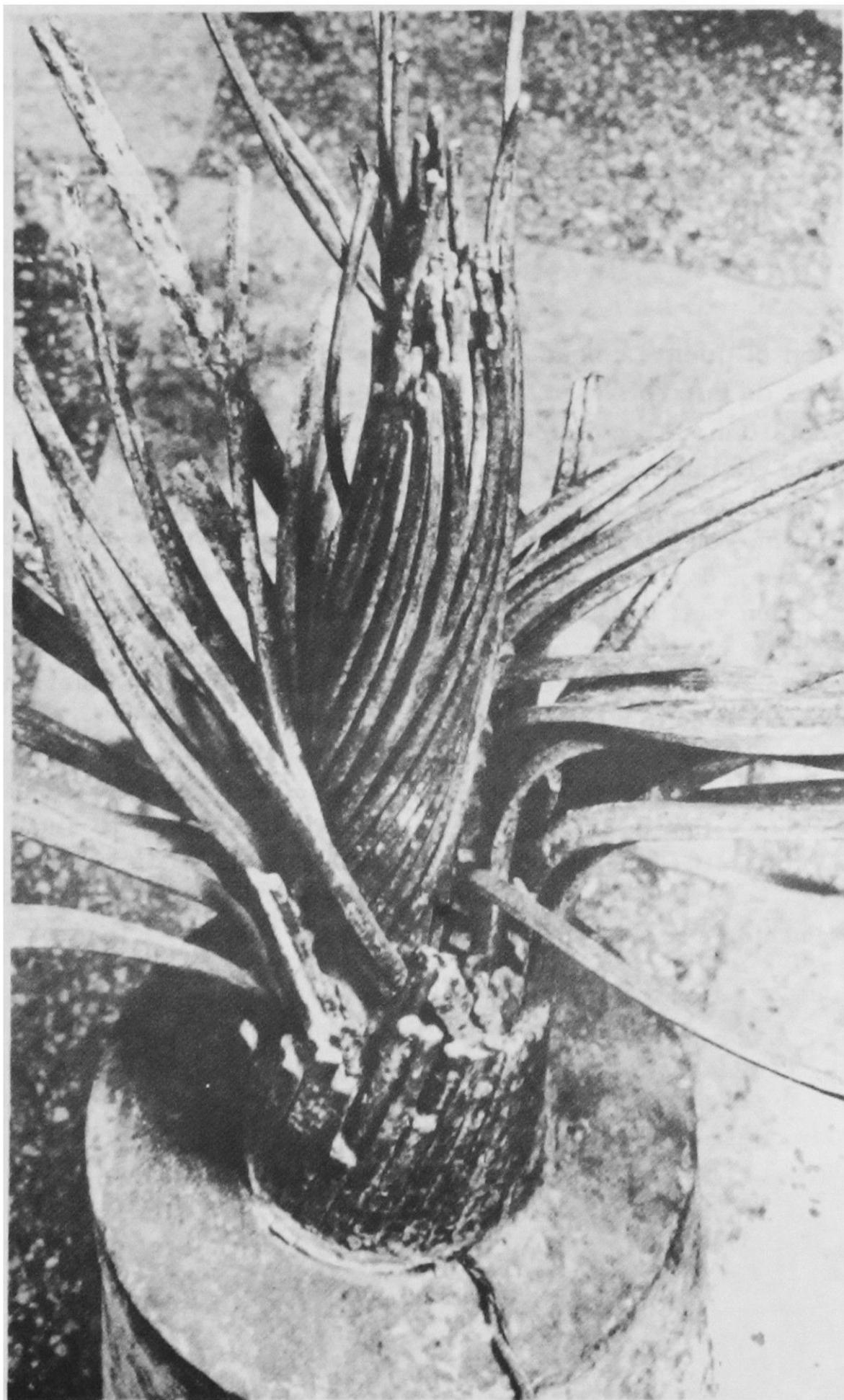
**Fig. 2. Zona de rotura del cable a la salida del cono de anclaje.**
