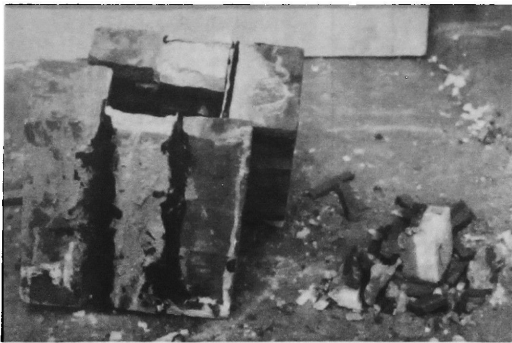
Fig. 20. Falla de probeta de cizalle reparada con cordón de resina. La falla se produjo por compresión del ladrillo central.
