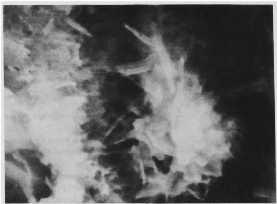
Fig. 6. Superficie de fractura de un cemento portland con un contenido de 10% de  $\text{CaSO}_4$ , luego de tres días de hidratación,  $a/c = 0.5$ . Se puede observar un agregado de agujas de aproximadamente 2000 Å, probablemente  $\text{C}_3\text{A}(\text{SO}_4\text{Ca})\text{H}_{12}$ . Microscopía electrónica de barrido. Según Kittl, Castro y Bretas<sup>21</sup>. 15 000 X.
