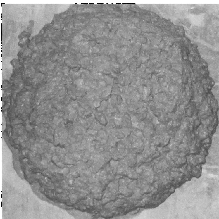
Fig. 2. Hormigón C-3, después del ensayo de desparramado: a) Hormigón base de 6 cm de asentamiento y 36 cm de desparramado. b) El mismo hormigón, pero con 1.5% de aditivo fluidificante 19 cm de asentamiento y 52 cm de desparramado.
